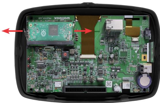
4. Die CPU bildet in der nicht gelösten Position einen spitzen Winkel von 45° mit der Basis der Steuerplatine.
