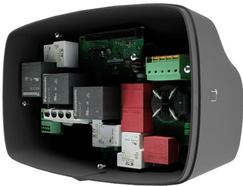
2. Verbinde alle Leiter mit der Steuerplatine an genau der gleichen Stelle, an der sie vorher waren. Vergewissere dich, dass du sowohl die Stromversorgungsleiter als auch die Leiter des Ladekabels in ihren jeweiligen Steckverbindern miteinander verbindest.
