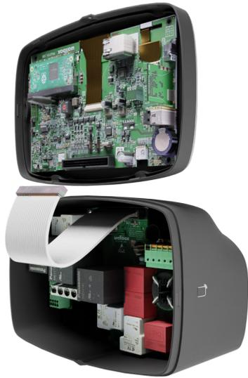
2. Sei vorsichtig und vergewissere dich, dass die CPU und die RFID-Karte auf der Steuerplatine unbeschädigt bleiben, während du die Frontabdeckung austauschst.
