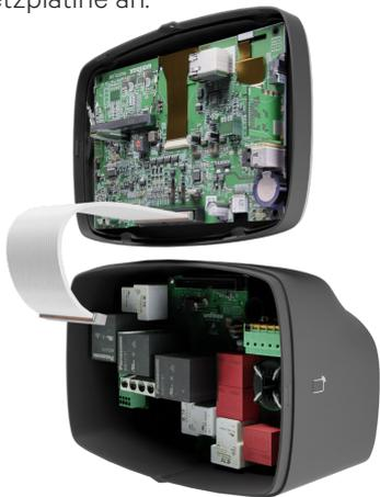
4. Positioniere die oberen Clip-Punkte der Frontabdeckung auf dem Ladegerät. Klemme zuerst die seitlichen und dann die unteren Clips an das Gehäuse des Ladegeräts an.
